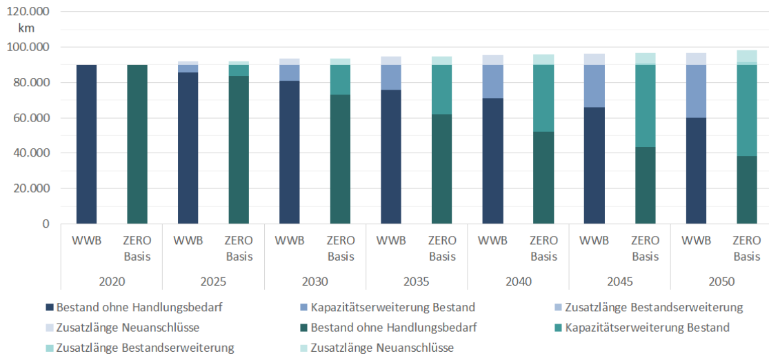
Bild A.1 Vergleich der Entwicklung der Leitungslängen der NE 7 der Szenarien WWB und ZERO Basis im zeitlichen Verlauf von 2020 bis 2050
